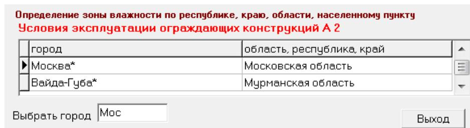
При определении города (согласно СНиП 23-01-99 «Строительная климатология») автоматически определяются условия эксплуатации ограждающих конструкций и зона влажности (для нашего примера: условия эксплуатации – «А», зона влажности – «2», как показано выше на рисунке). Эти данные нам будут необходимы для последующего расчета.
